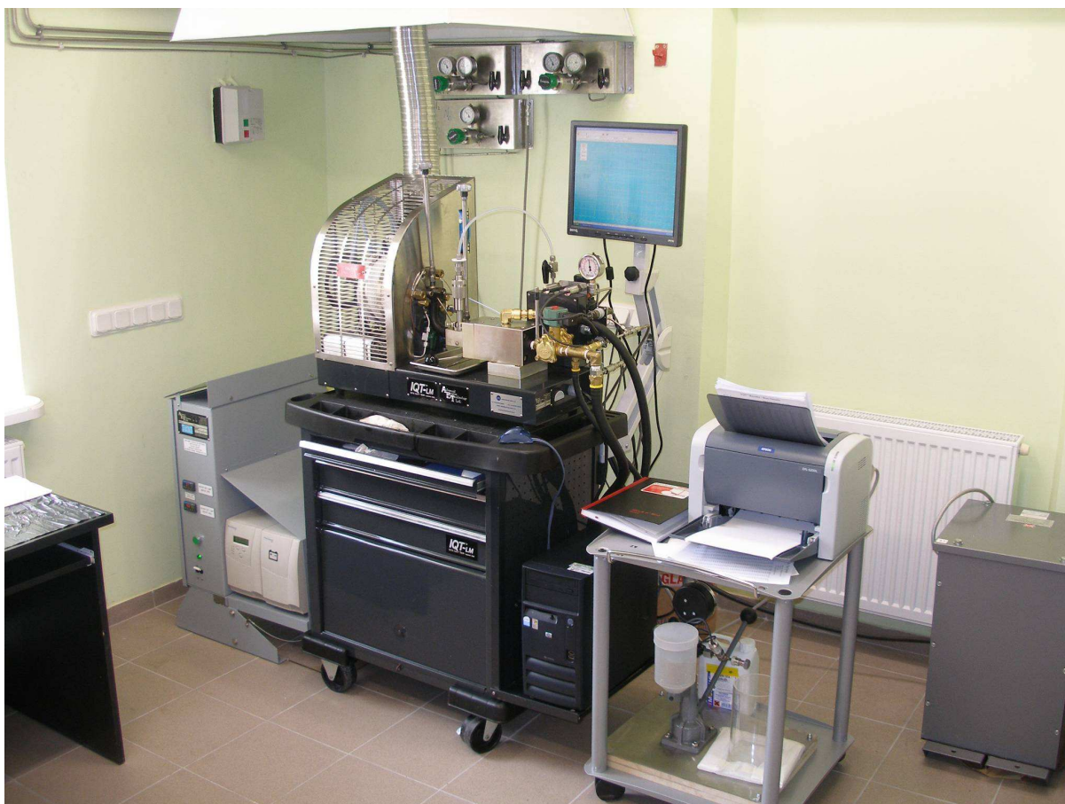
7.4.att. Stanhope-Seta (UK) ražotā cetānskaitļa noteikšanas iekārta.
