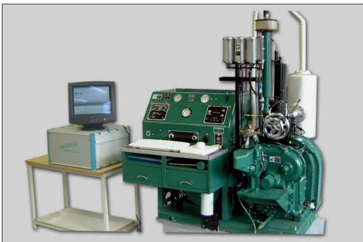
7.3.att. ASV ražotā cetānskaitļa noteikšanas iekārta.
